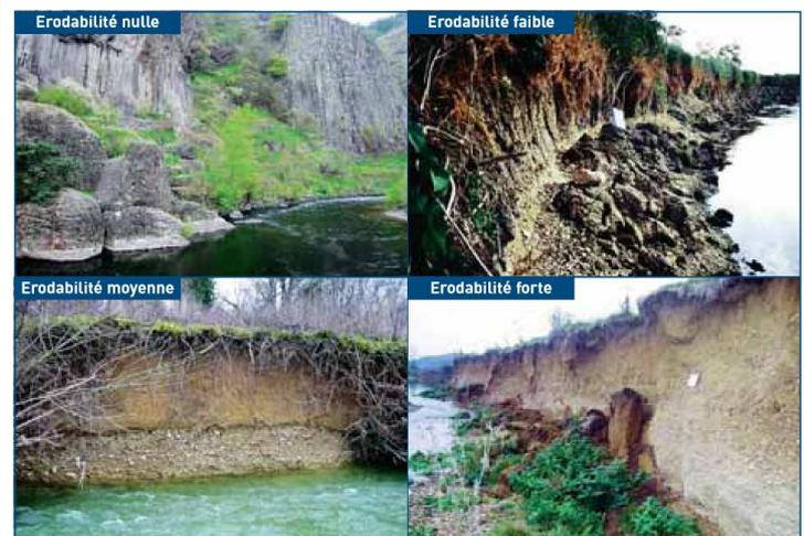
Figure 5 : Exemples visuels de divers degrés d'érodabilité de berges. ≈
